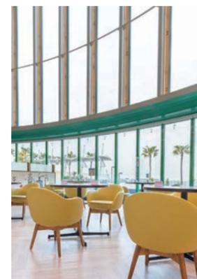
きれいな夕陽の見える海側の吹き抜け窓には(株)ZEROの窓ガラス用遮蔽コーティング「ZERO COAT」を塗布しています。効果として窓ガラス付近の温度上昇を5~10℃抑制し、冷房機器の電力使用量を約20%削減することが期待できます。
